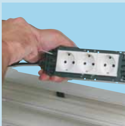
As tomadas Mosaic "especial DLP" com quadro são fornecidas já encaixadas no suporte. Ligação das tomadas por ligação bilateral rápida. Os ligadores são fornecidos abertos e as tomadas estão prontas a ser cabladas
