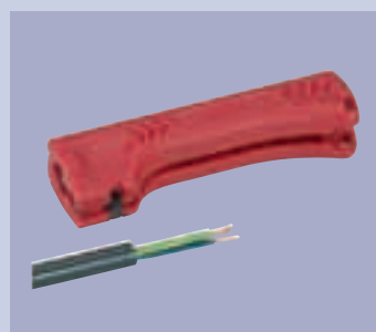
Descarnagem dos condutores de cobre
