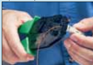
Etapa 6: cravação do conector
